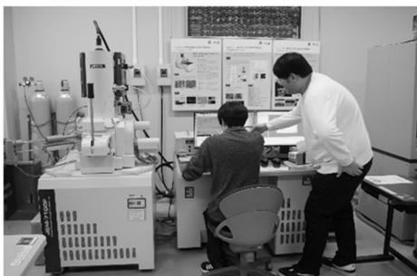
電界放出型走査電子顕微鏡 FE-SEM
